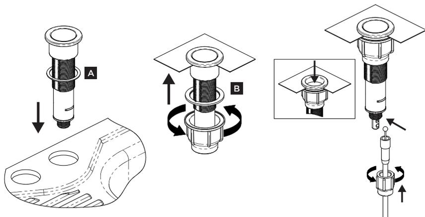
Stellen Sie die Edelstahlgitter des Auslasses der Spüle mit der Schraube in die optimale Position ein.
